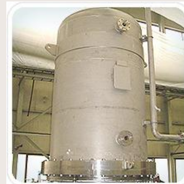
압력용기 제작기술이 적용된 CVD Reactor
