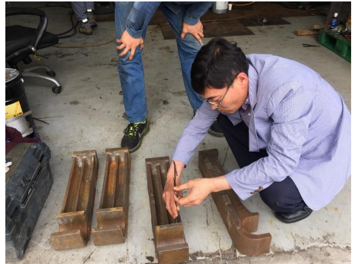
(↓) 전주사업부와 창원에너텍의 화격자 상태와 규격 측정 중인 여수사업부의 이영운 상무
