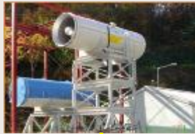
Dust collecting blast fan
